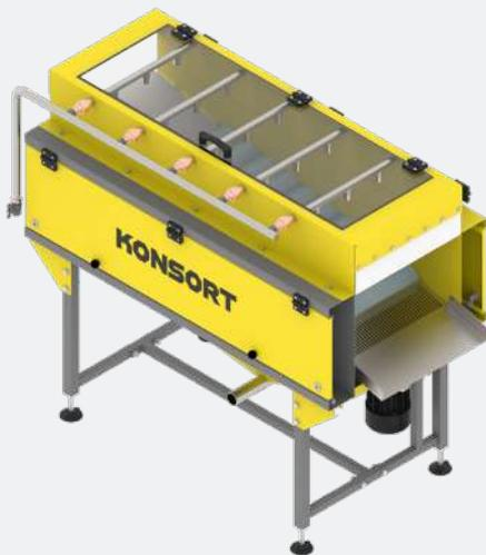
Продукт проходить наступні етапи: спочатку полуниця завантажується на щіткову мийку, після попереднього миття в барботажній машині. Далі сировину підхоплюють обертові щітки, завдяки яким очищується пісок з поглиблень в ягоді. Зверху, з форсунок йде омивання продукції проточною водою, яка потрапляє в зливний отвір, збоку від мийки. Чиста ягода може висипатися на інспекційні столи для подальшого сортування операторами.
