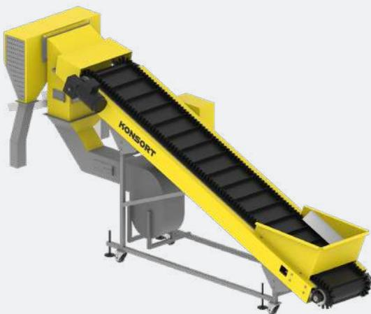
Стрічкова віялка для ягід призначена для очищення ягід від листя та дрібного сміття. Віялка мобільна, оснащена поворотними колесами.
