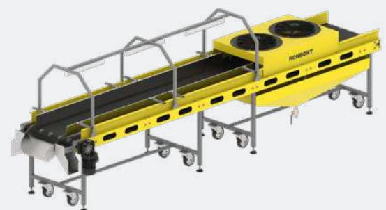
Конвеєр призначений для підсушування продукту і подальшого транспортування лінією. Сировина транспортується перфорованою конвеєрною стрічкою, під якою розміщений лоток для стікання вологи. Для зручності передбачено освітлення зони сортування продукції.
