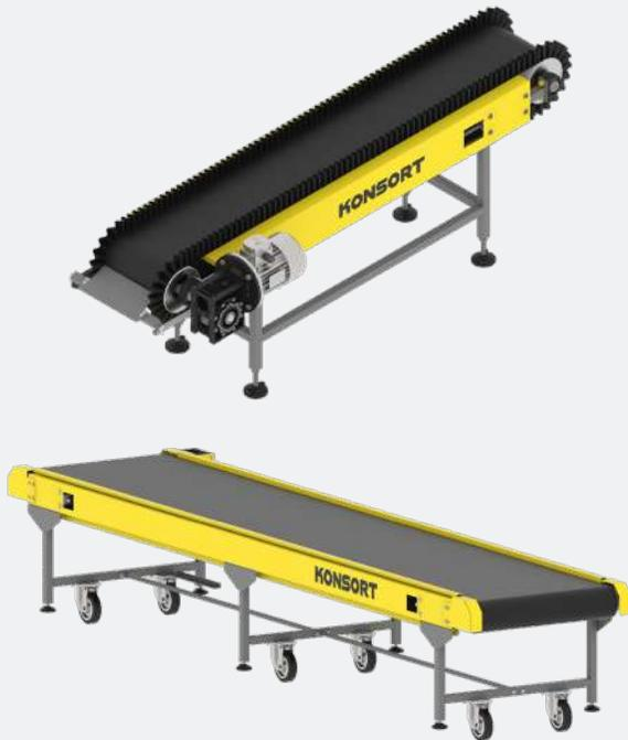
Конвеєр прямий з модульною стрічкою призначений для транспортування сировини та вантажів. Опори транспортера оснащенні поворотними колесами з гальмами. Стрічка рухається настилом. Для запобігання провисання стрічки передбаченні підтримуючі ролики, для регулювання натягу – натяжні механізми.
