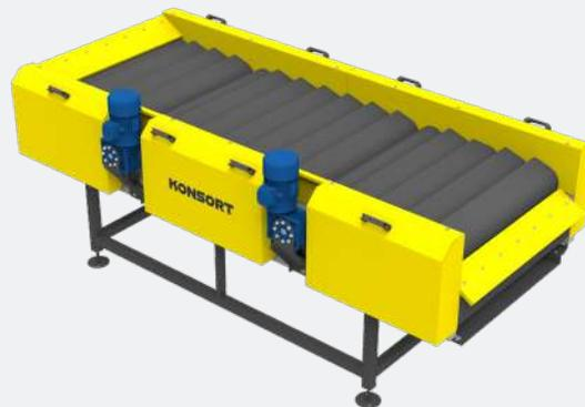
Сушка відбувається за рахунок обертових валів зі сталі з фетровим покриттям. Фетр всмоктує вологу з продукції, яка по ньому проходить, а додаткові ролики – під фетровими – вижимають з них вологу. Далі продукт прямує вивідним лотком до наступного етапу обробки. Фетр ідеально підходить для цієї задачі, оскільки якісно вбирає вологу та запобігає гниттю продукції.
