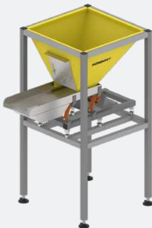
Вібробункер застосовується для дозованої подачі ягід на інспекційний стіл. Головною перевагою такого обладнання є перфорований лоток, який дає змогу провести попереднє сортування продукту, тобто відокремити від сміття та бруду.
