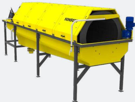
Барабанна мийка машина призначена для мийки фруктів і овочів з твердою структурою в технологічних лініях їх переробки. Миття відбувається шляхом тертя продукту об стінки барабана та один об один. Уздовж зони мийки продукція частково занурена у воду, яка подається через форсунки.
