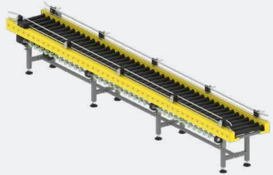
Конвеєр роликів привідний (рольганг) призначений для переміщення штучних вантажів із плоским дном, наприклад: коробок, палет, дерев'яних заготовок, лотків з продукцією тощо. Продукт переміщується роликами, які, на відміну від непривідного рольганга, приводяться в дію за допомогою мотор-редуктора, ланцюгів і зірочок.
