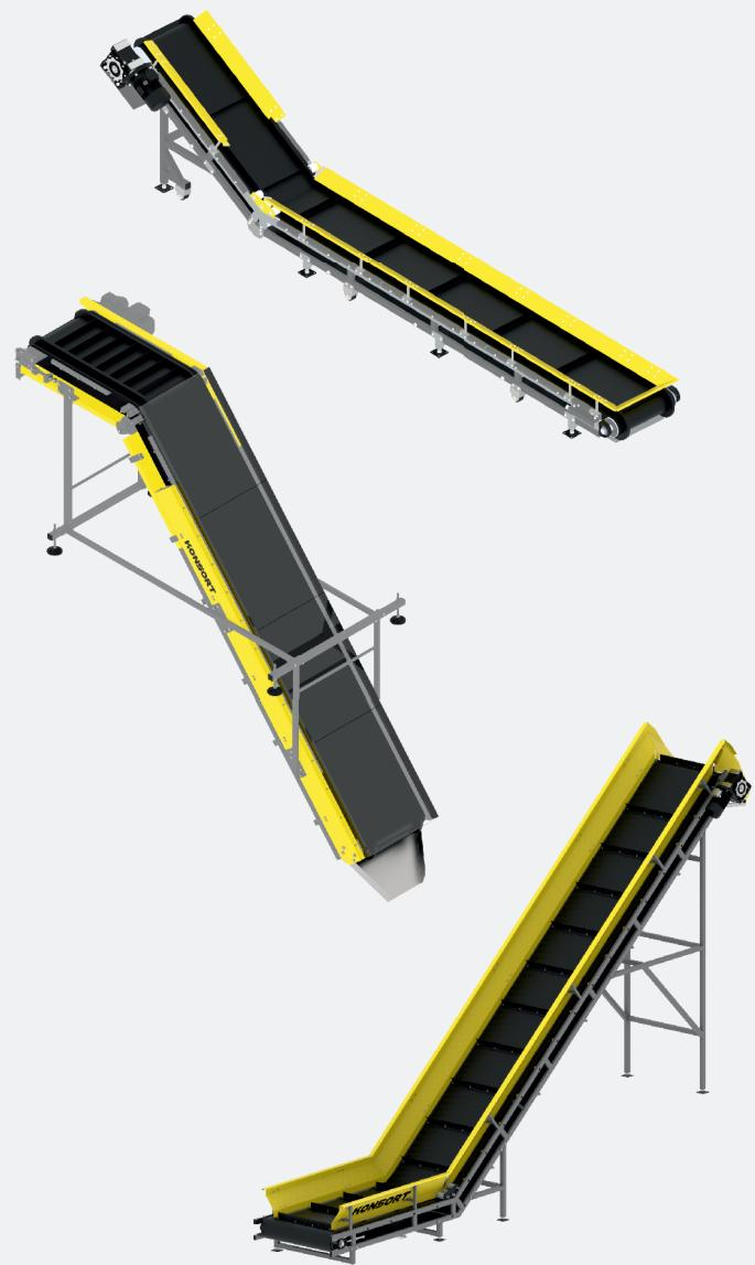
Конвеєр у вигляді букви «L» є чи не найзручнішим та найпростішим обладнанням для транспортування. Такі транспортери використовуються в разі, якщо потрібно скоротити площу виробництва без шкоди протяжності лінії. Інколи, конвеєри подібної модифікації можуть сягати 10-ки метрів. Обладнання оснащено мотор-редуктором з частотним перетворювачем.
