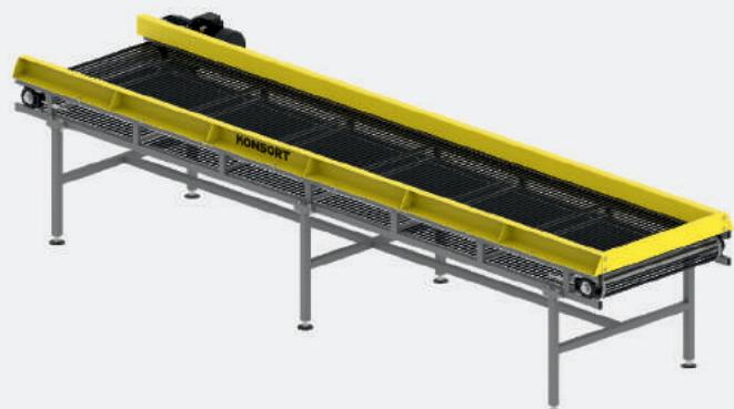
Прутковий конвеєр призначений для попереднього очищення продукту від лушпиння та дрібного сміття, для подальшої обробки та транспортування. Дане обладнання дозволяє зменшити економічні ризики, шляхом скорочення кількості працівників та прискорити процес обробки сировини. Матеріал виготовлення прутків – нержавіюча сталь ( марка AISI 304). Матеріал виготовлення бункера й рами транспортера – конструкційна сталь. Бункер обклеяно м'яким матеріалом для попередження псування продукції.
