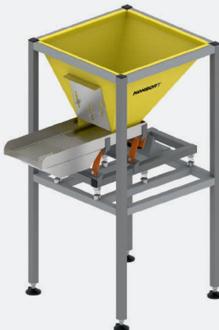
Вібробункер застосовується для дозованої подачі ягід на інспекційний стіл. Головною перевагою такого обладнання - є перфорований лоток, який дозволяє зробити предсортування продукту, тобто відокремити від сміття та бруду.
