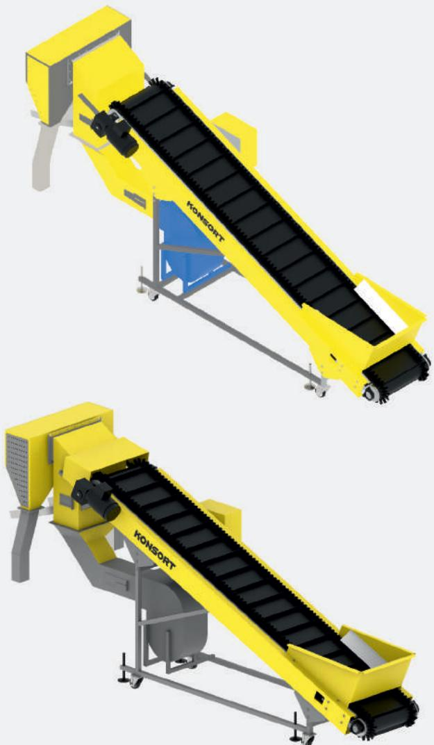
Стрічкова віялка для ягід - це обладнання нового покоління, призначене для очищення ягід від листя та дрібного сміття. Віялка мобільна, оснащена поворотними колесами, що розміщаються в оцинкованому корпусі. Рама конвеєру виготовлена з чорного металу. Приймальний бункер, обдувочну камеру і місця стику з продуктом виготовлено з нержавіючої сталі.
