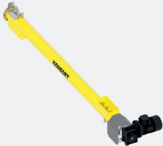
Шнекові конвеєри широко застосовуються як в сільському господарстві, так і в промисловості. Шнек має просту будову в основі якої знаходитьться гвинт. Він складається з спіралевидного валу, який обертається в жолобі, і має вхідний і вихідний отвори у корпусі. Матеріал трубо основи - нержавіюча сталь.
