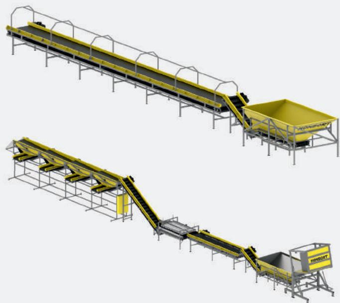
Автоматична лінія для промислової переробки часнику призначена для обробки сільгосппродукції в циклі харчового виробництва. Устаткування лінії часнику виготовляється індивідуально під замовлення, відповідно до вимог продуктивності і специфіки виду пакування готової продукції. Дані автоматична установка дозволяє здійснювати переробку сільськогосподарської продукції зі швидкістю до 10 т/годину.
