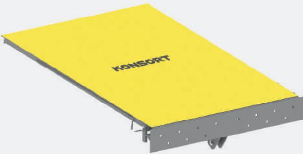
Відкидний міст може бути встановлений на пандус або раму, щоб компенсувати існуючі відмінності в висоті підлоги складу і кузова вантажівки. Найбільш оптимально використовувати таке обладнання, коли різниця висот не перевищує 360 мм. Конструкція може бути гідралічного/механічного типу.
