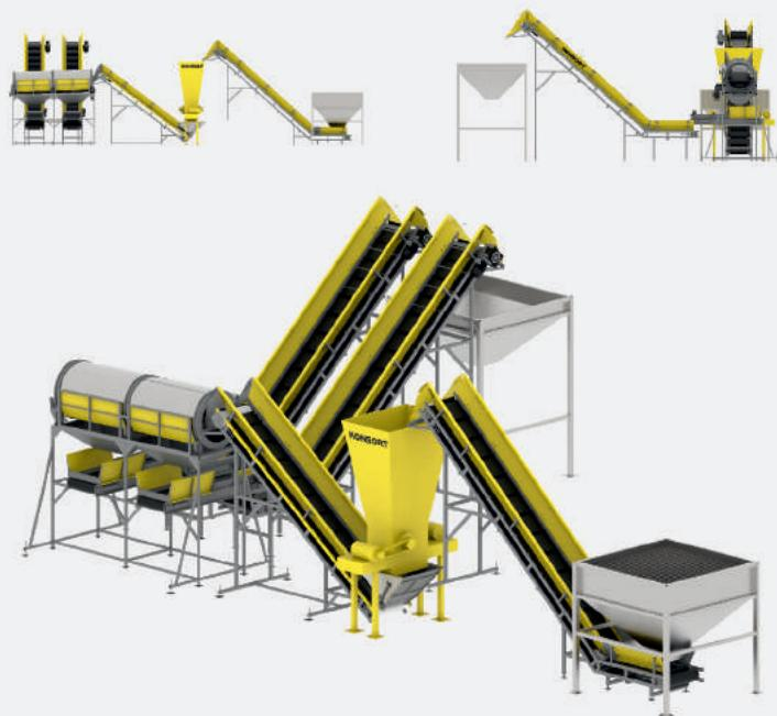
Система сортування та переробки сипучих продуктів складається з п'яти конвеєрів. Два конвеєри подають продукцію на транспортер з розподілюючим візком, який почергово завантажує бункер для зберігання сипучих. З боків конвеєрів є обмежувальні бортики з гумовими накладками, висотою 50 мм. Метал виготовлення рами: конструкційна сталь. Всі мотор-редуктори сортувальної системи виробництва Італії. Для транспортування використовується стрічка ПВХ з шевронами висотою 40 мм та кроком 200 мм.
