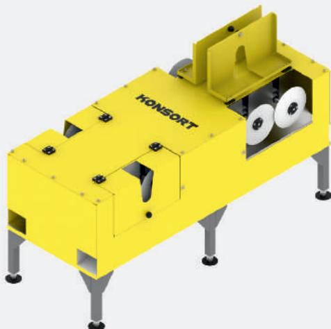
Станок для обрізки часника і цибулі значно полегшує цикл переробки, пов'язаний з обрізанням кореня і стебла продукту. Машина для обрізки розрахована на 2 чоловік. Є можливість регулювання швидкості обертання ножів за допомогою частотного перетворювача. Обладнання повністю відповідає всім стандартам та нормам безпеки.
