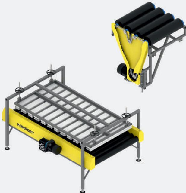
Роликовий конвеєр для очистки лушпиння застосовується на початку лінії переробки цибулі і часнику. За допомогою даного обладнання сировину можна легко очистити, за рахунок обертання роликів, не пошкоджуючи продукт. Зверху рольганг закритий кожухом, на довжину якого встановлені плоскі щітки, за допомогою яких і відбувається процес очищення.
