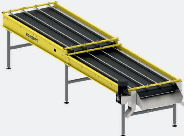
Дворівневий інспекційний стіл - обладнання, призначене для візуального контролю якості сипучої продукції, яка підлягає подальшій обробці (смаженню, сушінню, миттю) або упаковці. На початку конвеєра знаходиться бункер з шиберною засувкою і магнітним вібратором. Бункер виготовлений з харчової нержавіючої сталі.
