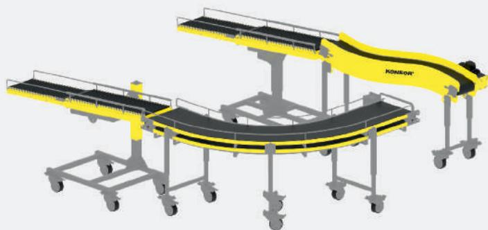
Лінія для транспортування банок з фарбою складається з двох телескопічних рольгангів і двох модульних поворотних конвеєрів. Данна лінія подає банки з фарбою різного діаметру на фасувальний апарат і на апарат вакуумування. Враховуючи обмеженість у площі виробничого приміщення клієнта конвеєри виконанні з незвичними S-подібними поворотами.
