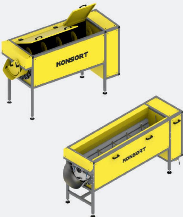
Щіткова мийка призначена для миття овочів: картоплі, моркви, буряка, топінамбура. Продукт миється в барабані, який обертається в ємності з водою. Рівень води в миючій машині регулюється. Водяний відцентровий насос омиває продукт сильними струменями води через систему форсунок.
