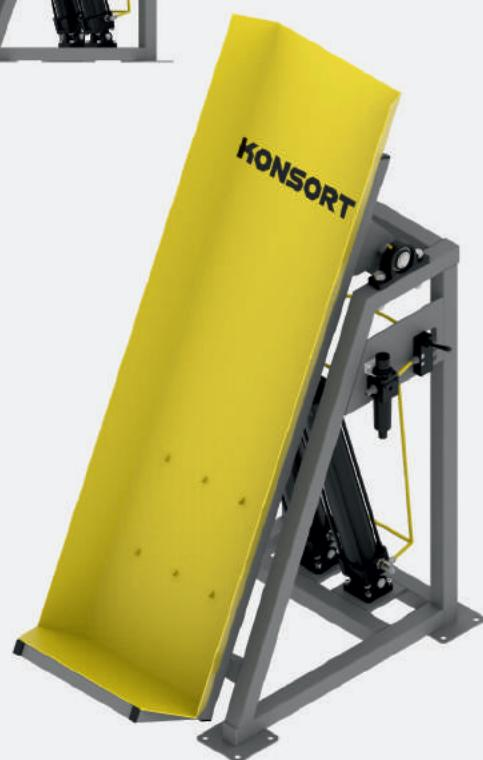
Перекидач мішків забезпечує швидке, легке та безпечне вивантаження продуктів. Обладнання призначено для підйому мішків з продуктом і перекидання їх в бункер-накопичувач або для подальшого транспортування по лінії. Перекидач приводиться в рух за допомогою пневмоциліндра.
